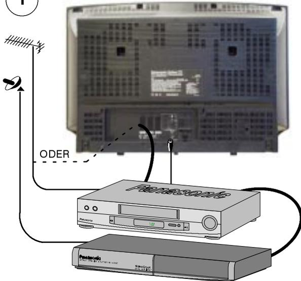
Antenne einstecken und Zubehör anschließen
